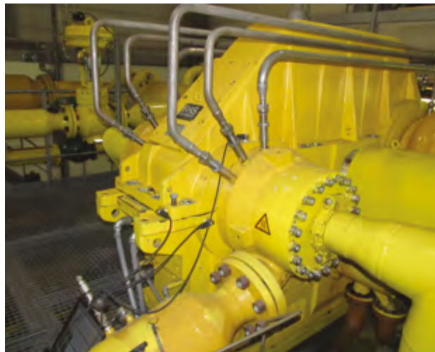
Vibrace měříme nejen na obráběcích strojích – turbokompresor – trendování vibrací
