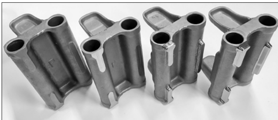
Oprava opotřebeného článku pásu BVP1; otěruvzdorná ocel, hmotnost návaru 0,3 kg, celkový čas opravy 35 min (od upnutí po vyjmutí)
