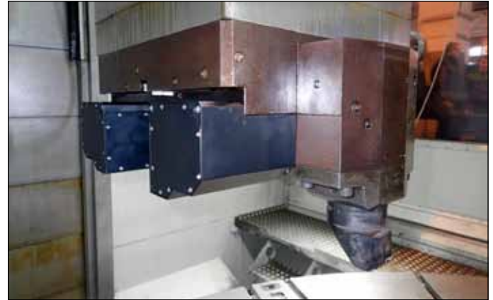
Obr 2: Soustružnický adaptér s integrovaným hltičem na karuselu firmy TOSHULIN, a.s.
