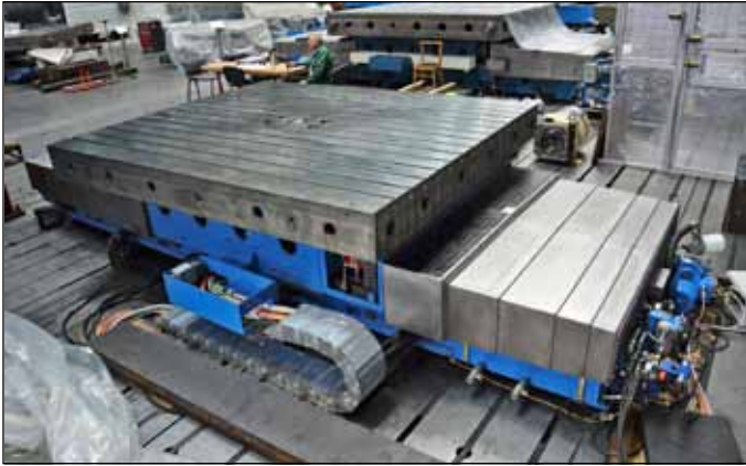
Obr 1: Otočný stůl TVD50 firmy Škoda Machine Tool, a.s. s optimalizovanou strukturou a hydrostatickým vedením
