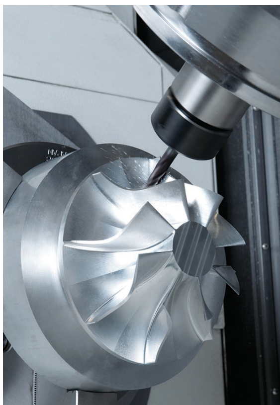
■ OBRÁBĚNÍ LOPATKOVÉHO KOLA NA PĚTIOSEM FRÉZOVACÍM CENTRU FIRMY MAZAK
