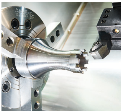
■ OBRÁBĚNÍ KOVOVÉ ŠACHOVÉ FIGURKY POMOCÍ SOUSTRUŽENÍ (TOČÍ SE SOUČÁSTKA).
