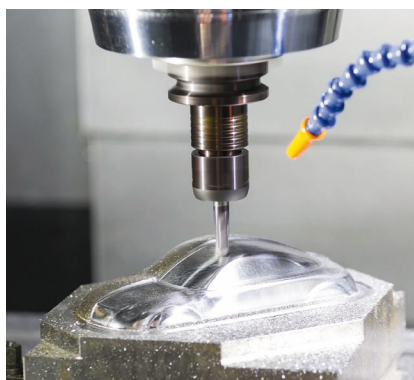
■ OBRÁBĚNÍ FORMY POMOCÍ FRÉZOVÁNÍ (TOČÍ SE NÁSTROJ) PRO BUDOUCÍ MODEL AUTÍČKA.
