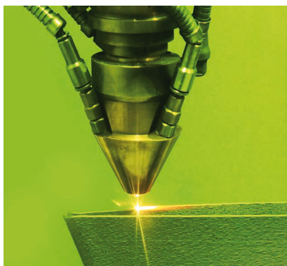
■ 3D TISK, NEBO TAKÉ ADITIVNÍ VÝROBA KOVOVÉ SOUČÁSTKY POMOCÍ LASEROVÉHO NAVÁŘOVÁNÍ KOVOVÉHO PRÁŠKU.
