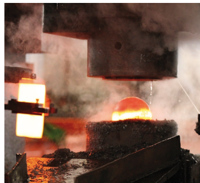
■ TVÁŘENÍ OHŘÁTÉHO OCELOVÉHO VÁLEČKU POMOCÍ KOVÁNÍ DO TVARU KOULE PRO BUDOUCÍ VELKÁ LOŽISKA.
