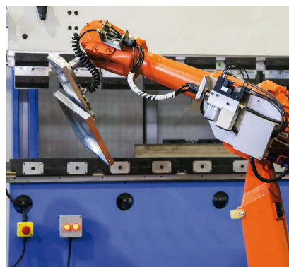
■ TVÁŘENÍ KOVOVÉHO PLECHU OHÝBÁNÍM. ROBOT SPOLUPRACUJE S OHRAŇOVACÍM LISEM (V POZADÍ).
