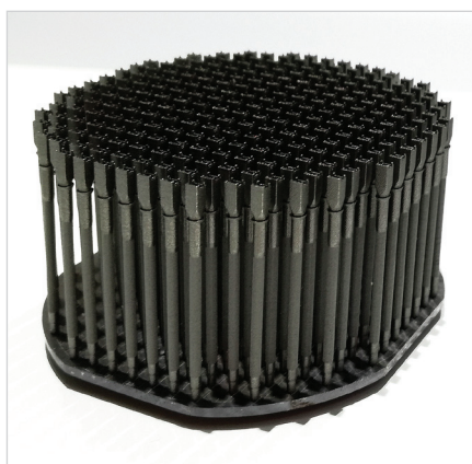
Filtrační trubičky o průměru 2 mm a s dírkami po obvodu o velikosti 50 µm byly vyrobeny metodou SLM na stroji DMG Mori.
