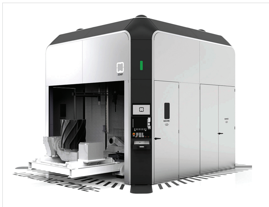
Stroj od firmy Gefertech provádí obloukové MIG/MAG svařování. Produktivita stroje pro vybrané výrobky přesahuje hodnotu 2 kg za hodinu. Zajímavostí je, že design stroje byl převzat z klasické 3D tiskárny na plasty, pouze v měřítku 10:1.
